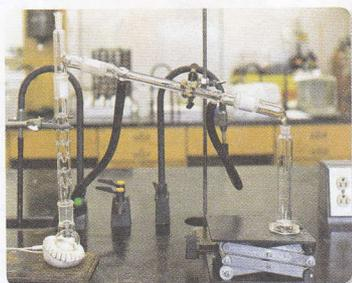
Instalație de distilare realizată în laborator
